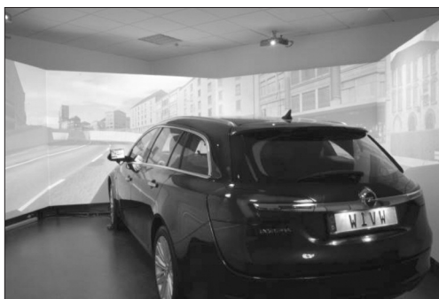
Abb. 1: Der statische Fahrimulator des WIVW: Ein voll instrumentierter Opel Insignia dient als Mockup. Das frontale Sichtfeld ermöglicht eine nahezu vollständige Rundumsicht (300 ° horizontal, 47 ° vertikal). Die Spiegel sind als LCD-Displays ausgeführt.
