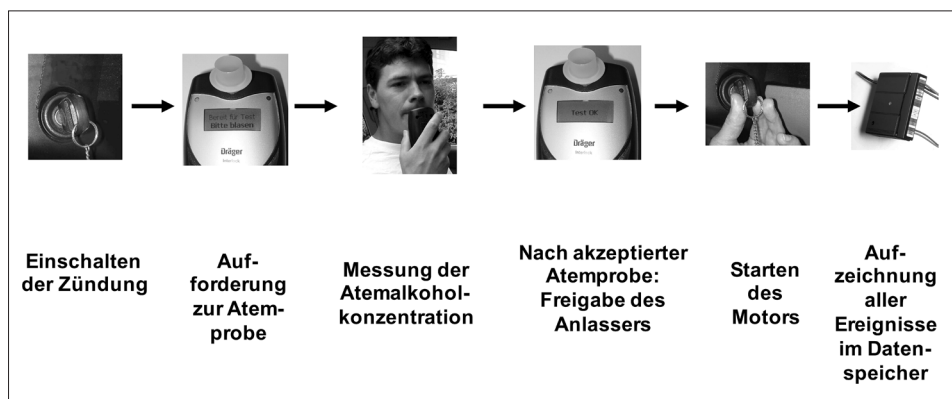
Abb. 2: Ablauf beim Starten eines Fahrzeugs mit AI-System.
