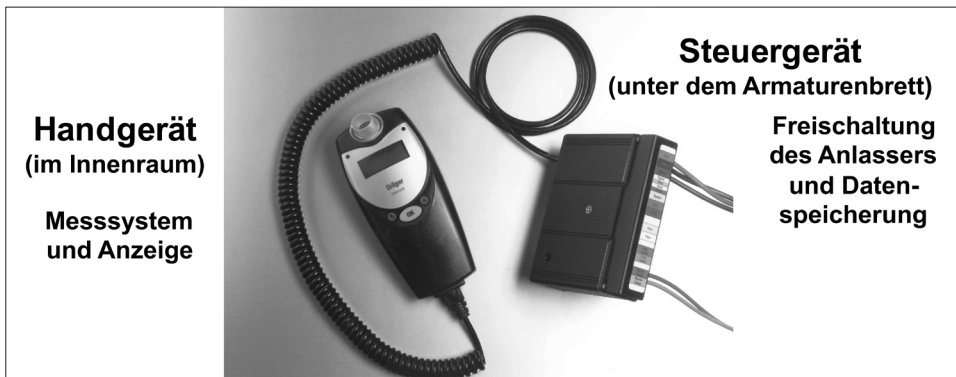
Abb. 1: AI-System mit den zwei Komponenten Hand- und Steuergerät.
